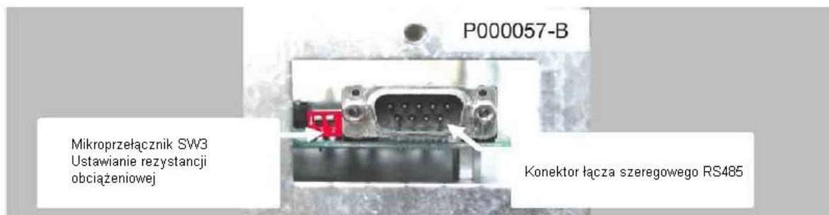
Rys. 33 Dostęp do mikroprzełączników i złącza RS-485.
